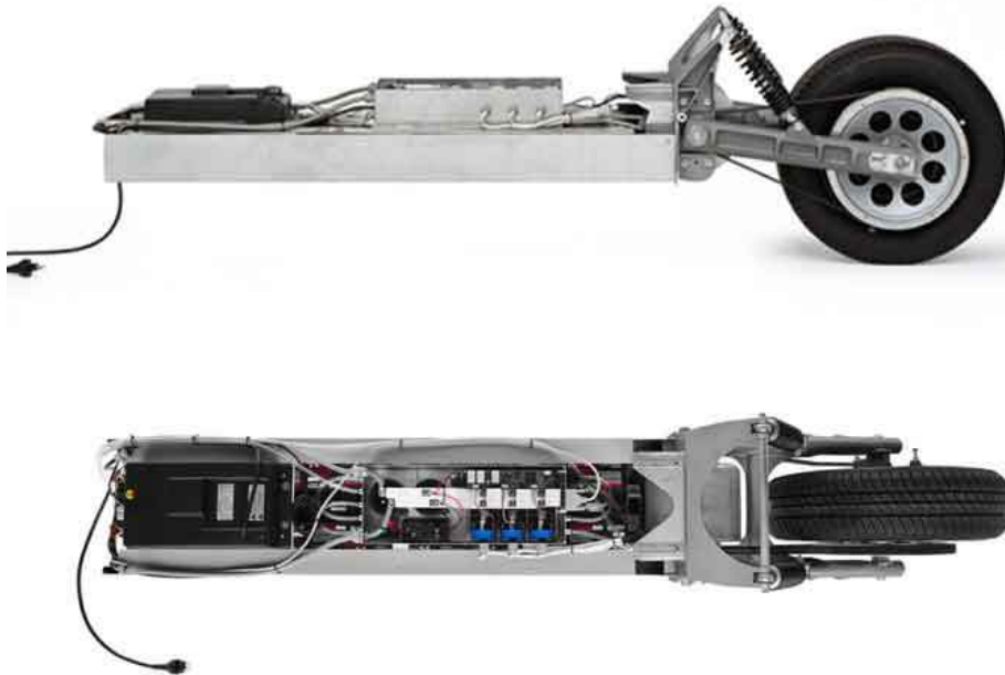
Abb. 163 Antriebseinheit von Cree, Quelle http://www.cree.ch
