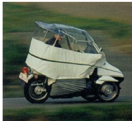
Abb. 123 : Verkleidetes 3-rädriges Motorrad, Quelle http://www.cx500c.de/cx_artikel/1984_02_motorrad.htm
