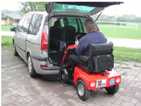
Abb. 127 Mitnahmemöglichkeit des Behindertenfahrzeuges im MiniVan, Quelle Graf carello
