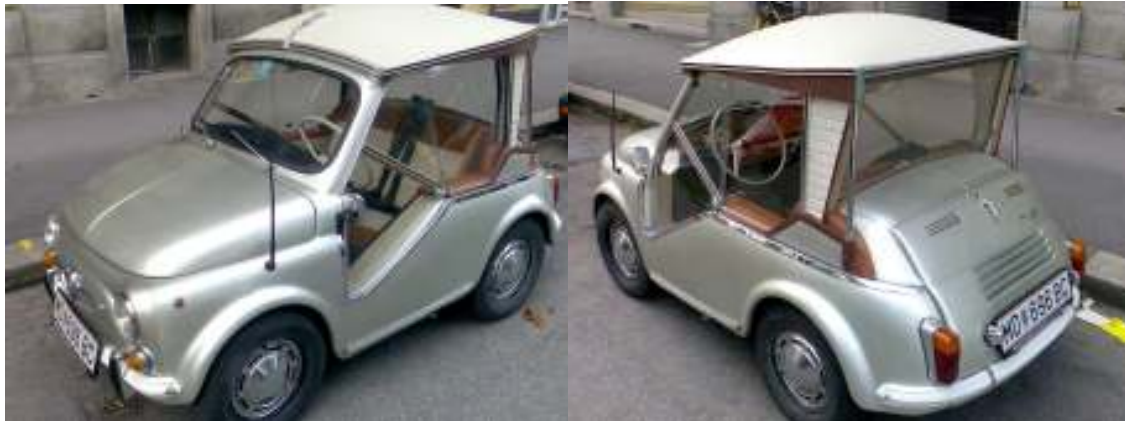
Abb. 128 Sacher Puch 500 mit um 0,5m verkürztem Radstand, Quelle eigene Aufnahme 29.7.07 Graz
