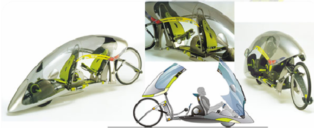
Abb. 133: Quelle neilfoleydesigns.com Das Konzept ähnelt einem Liegerad-Tandem und hat eine sehr tiefe Sitzposition.
