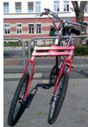
Abb. 4 Nachrüstlösung Neigevorderteil – Quelle eigen Aufnahme, Patent beantragt Forschungsgesellschaft Mobilität 2007
