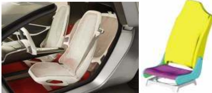
Abb. 166 leichter und belüfteter Sitz – vorgespannte oder GFK-Konstruktion Quelle http://www.leichtwerk.com/en/other/index.html
