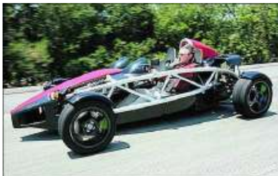
Abb. 162 Leichtbau und Sicherheit durch Gitterrohrrahmen in einem Straßen Sportwagen Quelle http://www.wrightspeed.com bzw. http://www.arielmotor.co.uk/
