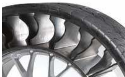
Abb. 168 Neue Reifentechnologie ohne Gasfüllung Quelle http://www.michelin.de/de/news/news_detail.jsp?id=14526&codeRubrique=1080
